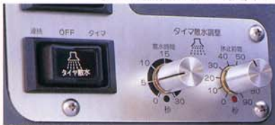
散水装置操作スイッチ
