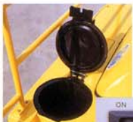
水タンク点検窓
